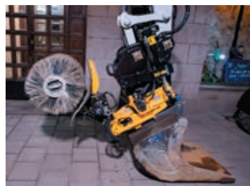
Engcons sopvalsar finns från 800 till 2000 millimeters bredd.
