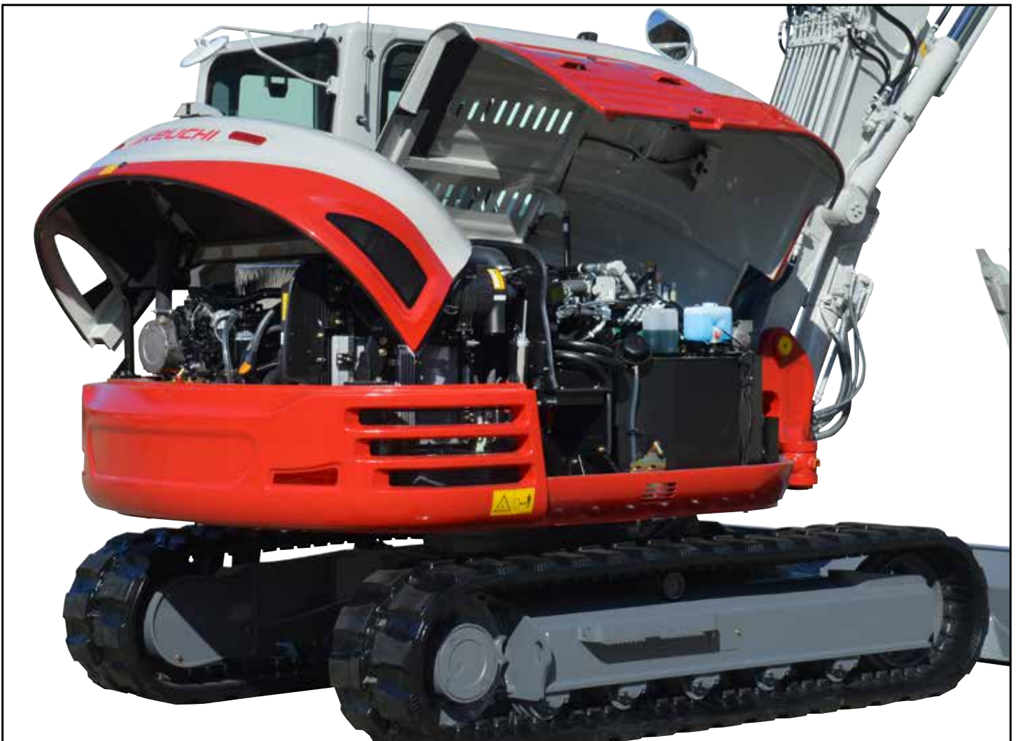
Stora, låsbara servicehuvar ger vandalskydd och enkel åtkomst för service och underhåll
